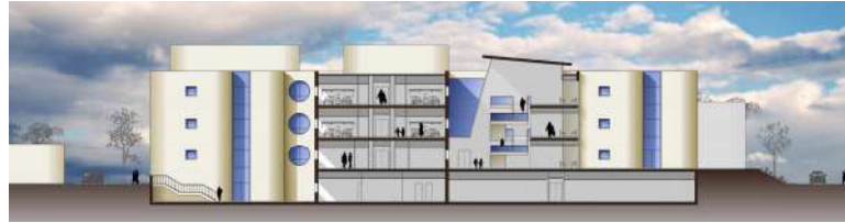
SECCION TRANSVERSAL DEL HOSPITAL
